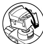
Encajar la tapa sobre la válvula servopilotada. Después de esto, el accionamiento manual auxiliar se acciona moviendo la corredera de la tapa ciega.
