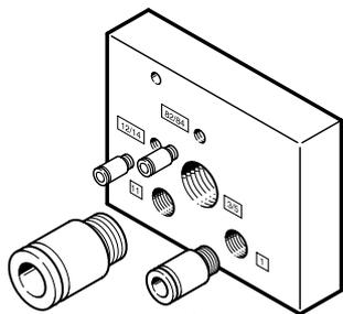
Ejemplo de una placa final: la imagen muestra una placa final a la izquierda con alimentación externa del aire de pilotaje. Las conexiones de descarga 3/5 y 82/84 pueden estar provistas de un racor o silenciador. En una placa final para la alimentación interna del aire de pilotaje, faltan las conexiones 12/14 y 11.
