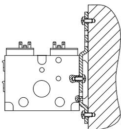
Para batería de válvulas CPV10: CPV10/14-VI-BG-RWL-B (Fijación, código U)
