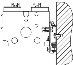
Para batería de válvulas CPV10: CPV10/14-VI-BG-NRH-35 (Fijación, código H)
