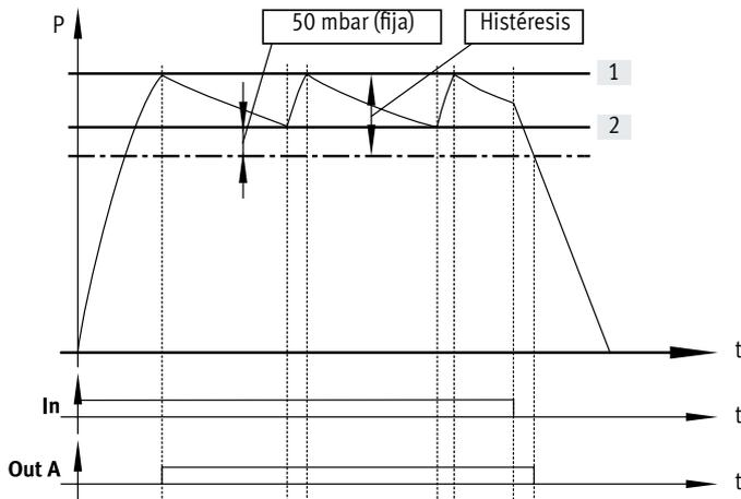
Si se alcanza el valor umbral [1] deseado para el vacío, la generación de vacío se desconecta automáticamente. Una válvula de antirretorno evita la caída del nivel de vacío.
