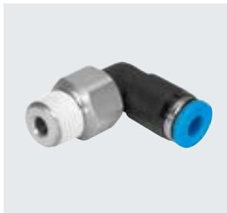
Racor rápido roscado con junta basculante, orientable 360°. El cojinete de bolas permite movimientos giratorios de hasta 500 rpm. Para aplicaciones neumáticas con un margen de temperatura de hasta 60 °C y un margen de presión de hasta 14 bar. Diámetro exterior del tubo flexible de 4, 6, 8, 10 y 12 mm con rosca de conexión M5, R1/8 ... R1/2 y G1/8 ... G1/2.
