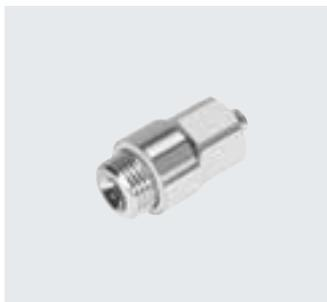
Racor de acero inoxidable para el uso en áreas expuestas a limpieza intensiva. Máxima resistencia a la corrosión CRC 4. Para aplicaciones neumáticas con un margen de temperatura de hasta 120 °C y un margen de presión de hasta 12 bar. Diámetro exterior del tubo flexible de 6 mm con rosca de conexión G1/8.
