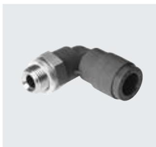
Racor rápido roscado ignífugo para la utilización en cualquier zona con peligro de incendio, por ejemplo, en equipos de soldadura en la industria automovilística o en el sector de la construcción. Para aplicaciones neumáticas con un margen de temperatura de hasta 60 °C y un margen de presión de hasta 10 bar.
