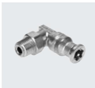
Racor rápido roscado de acero inoxidable. Máxima resistencia a la corrosión CRC 4 y a sustancias químicas; con certificación para la industria alimentaria y del envasado. Para aplicaciones neumáticas con un margen de temperatura de hasta 120 °C y un margen de presión de hasta 10 bar.
