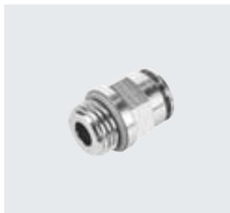
Racor metálico de latón macizo, niquelado químicamente. Resistencia a la corrosión elevada CRC 3 y a las sustancias químicas. Para aplicaciones neumáticas con un margen de temperatura de hasta 150 °C y un margen de presión de hasta 20 bar.
