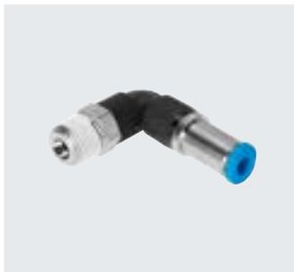
El racor rápido roscado bloquea el flujo de aire después de soltarse el tubo flexible. Para aplicaciones neumáticas con un margen de temperatura de hasta 60 °C y un margen de presión de hasta 14 bar. Diámetro exterior del tubo flexible de 4, 6, 8, 10 y 12 mm con rosca de conexión M5, R1/8 ... R1/2 y G1/8 ... G1/2.
