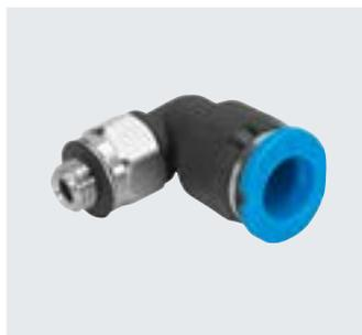
Racor rápido roscado de pequeñas dimensiones para lograr la máxima densidad de montaje en espacios reducidos. Para aplicaciones neumáticas con un margen de temperatura de hasta 80 °C y un margen de presión de hasta 14 bar.
