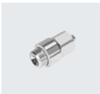
Racor de acero inoxidable para el uso en áreas expuestas a limpieza intensiva. Máxima resistencia a la corrosión CRC 4. Para aplicaciones neumáticas con un margen de temperatura de hasta 120 °C y un margen de presión de hasta 12 bar.
