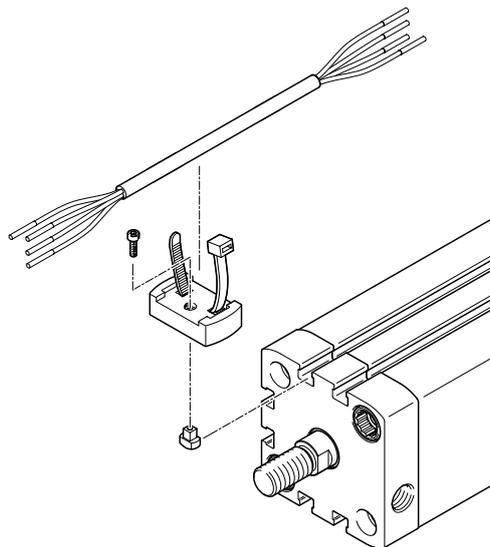
El kit de fijación garantiza un montaje seguro en ranuras en T de Festo. La geometría del retenedor y de la tuerca deslizante está adaptada con precisión al mismo.
