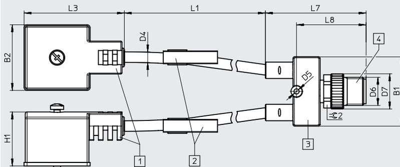
[1] Zócalo, lado del equipo de campo      [2] Placa de identificación      [3] Distribuidor      [4] Conector, lado de control
