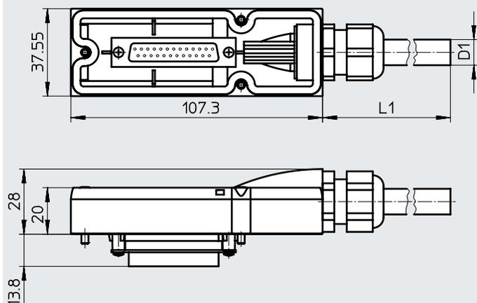
L1 Longitud según el tipo (2,5 m, 5 m o 10 m)
