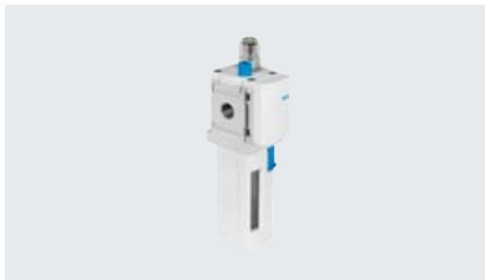
El lubricador proporcional suministra al aire comprimido una cantidad de aceite dosificada con precisión. La caída de presión que se produce al pasar el aire por una tobera Venturi sirve para transportar el aceite desde un depósito hasta la tapa de goteo.
