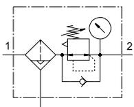
En este equipo, el filtro y el regulador de presión forman una unidad. El filtro sinterizado con separador de agua elimina del aire comprimido las partículas de suciedad, los depósitos minerales de los tubos, las partículas de óxido, así como la condensación.
