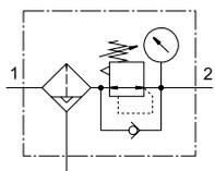
En este equipo, el filtro y el regulador de presión forman una unidad. El filtro sinterizado con separador de agua elimina del aire comprimido las partículas de suciedad, los depósitos minerales de los tubos, las partículas de óxido, así como la condensación.
