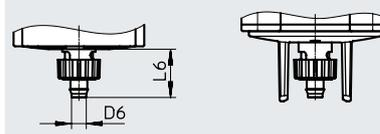
Boquilla estriada para tubo de plástico
