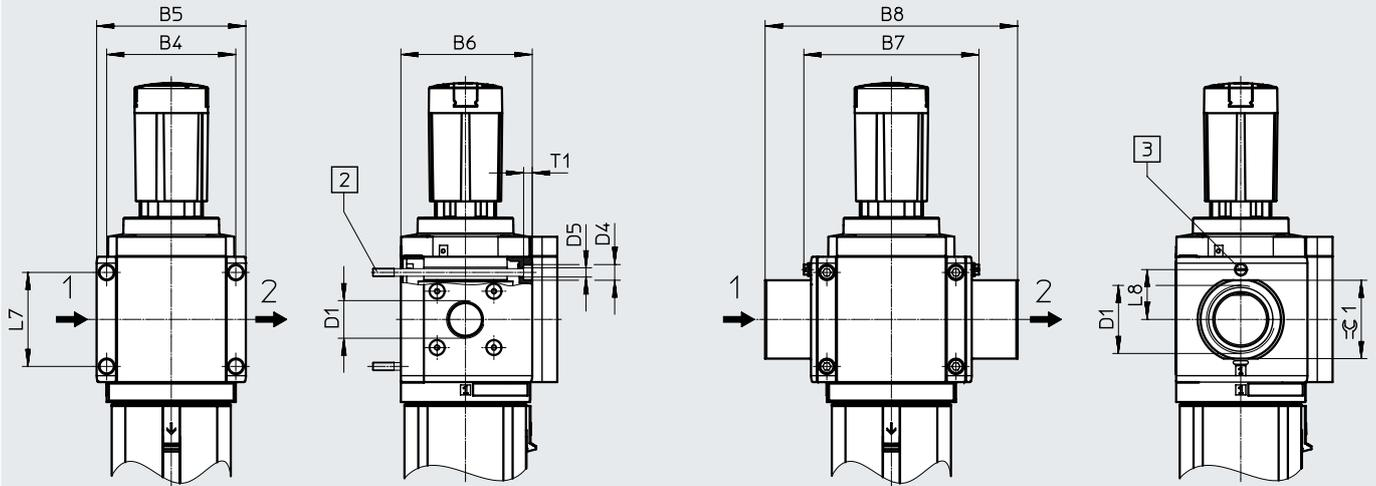
[2] Tornillo de fijación M6xmn.90 según DIN 912 (no incluido en el suministro) para el montaje mural sin escuadra de fijación
