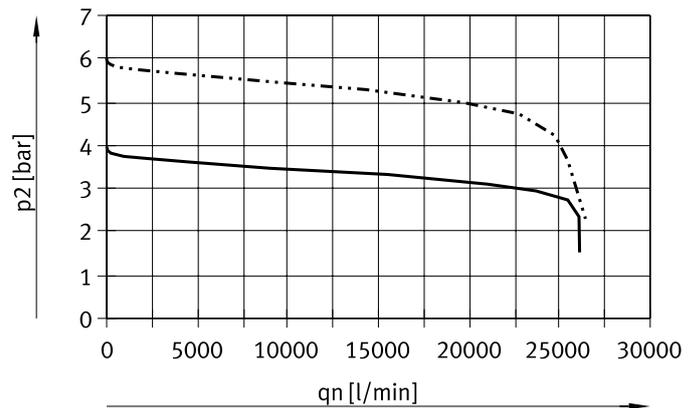
**Caudal normal qn en función de la presión de salida p2 con presión de funcionamiento p1 = 10 bar**
