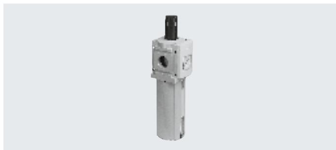
En este equipo, el filtro y el regulador de presión forman una unidad. El filtro sinterizado con separador de agua elimina del aire comprimido las partículas de suciedad, los depósitos minerales de los tubos, las partículas de óxido, así como la condensación.
