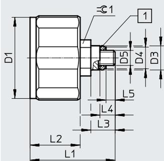
[1] Con anillo de junta de poliamida premontado
