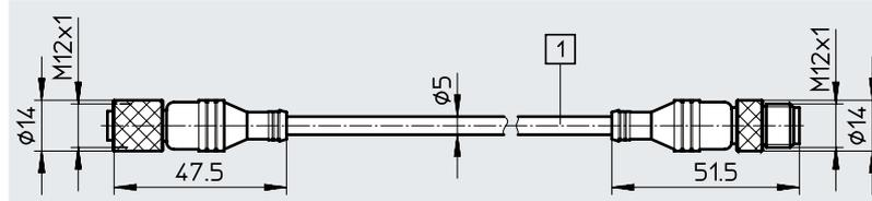
[1] Cable de 1,5 m o 3,5 m de longitud según pedido
