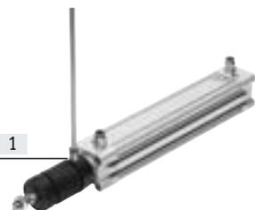
El conjunto de fuelles es un sistema estanco. Con el fin de evitar la aspiración de medios no deseados, el aire de alimentación y de escape se conducen de forma conjunta a través de un orificio de compensación de presión en la pieza de conexión [1].
