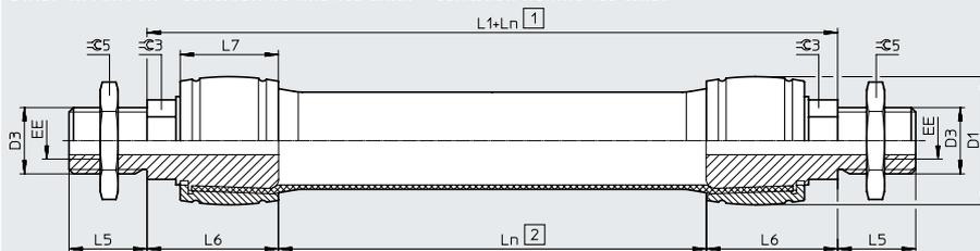
DMSP-...-RM-CF – conexión neumática radial – sin conexión, con rosca interior
