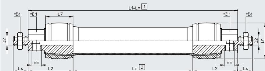
DMSP-...-AM-RM – conexión neumática axial – conexión neumática radial
