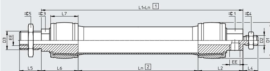
DMSP-...-AM-CM – conexión neumática axial – sin conexión, con rosca exterior
