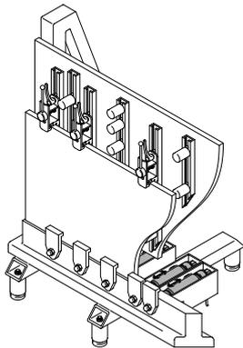
El músculo neumático permite sujetar fácilmente piezas grandes y difíciles de manipular, como placas, paredes o piezas laterales que se deben mecanizar (torneado, taladrado, fresado). Aquí juegan un papel fundamental las excepcionales características del músculo, como su gran fuerza con un diámetro pequeño, movimientos sin fricciones ni sacudidas, resistencia a la suciedad (virutas, abrasión) y, por último, su estructura hermética.
