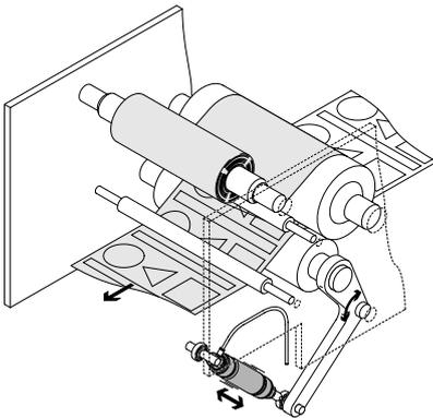
El músculo neumático es especialmente útil para la presión de contacto de rodillos. La presión de contacto se puede modificar mediante la presión de funcionamiento. Su estructura sin componentes fijos hace que no se produzcan picos de fuerza. El músculo neumático es hermético y se puede separar de la alimentación de aire comprimido. Pese a ello, continúa cumpliendo con su función.
