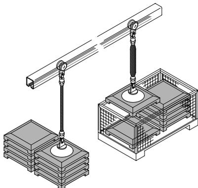
¿Desea utilizar posiciones intermedias? Con la regulación de la presión es muy fácil: con una válvula de palanca manual se aumenta o reduce la presión dentro del músculo neumático, de forma que las piezas pueden elevarse o descenderse hasta la altura deseada. Con músculos de hasta 9 metros de largo es posible encontrar soluciones óptimas para numerosas aplicaciones.
