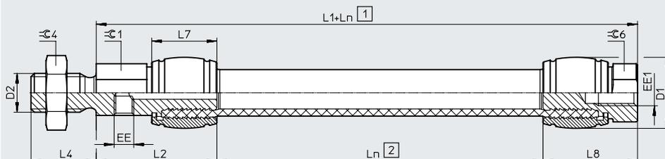
DMSP-...-AM-CF – conexión neumática axial – sin conexión, con rosca interior
