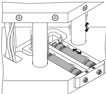
En los procesos de unión como, por ejemplo, los que se producen en las máquinas de soldadura, el músculo neumático se encarga de sujetar durante el proceso los componentes que se van a soldar. También en este ámbito de aplicación, la gran fuerza con un pequeño diámetro que posee el músculo es de gran utilidad.
