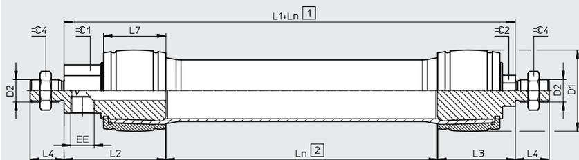
DMSP-...-RM-RM – conexión neumática radial – conexión neumática radial
