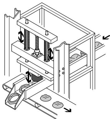
El músculo neumático permite alcanzar grandes tasas de ciclos. Por un lado, gracias a que pesa muy poco. Por otro, porque no tiene piezas móviles (por ejemplo, no tiene émbolo). La estructura sencilla del músculo, pretensado mediante dos muelles, puede sustituir un complicado sistema de sujeción mediante palanca articulada con cilindros.
