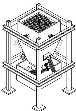
Durante el proceso de alimentación en depósitos o silos suelen producirse bóvedas de material que ocasionan problemas. En la práctica, para evitar que se forme una bóveda, se utilizan auxiliares de descarga, como dispositivos vibradores o sacudidores. Esta función puede realizarse utilizando el músculo neumático. La frecuencia se puede configurar de forma progresiva hasta los 150 Hz y de manera independiente de la amplitud. De este modo se asegura un transporte continuo.
