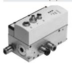
Válvula distribuidora proporcional de 5/3 vías para aplicaciones con Soft Stop y posicionamiento neumático. Plenamente digitalizada: con sensores de presión integrados y con nuevas funciones de diagnosis. Disponible en los tamaños 4, 6, 8 y 10.
