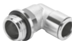
Racor metálico a un precio atractivo para aplicaciones neumáticas con un margen de temperatura de hasta 70 °C y un margen de presión de hasta 16 bar.
