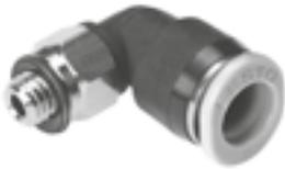
Racor rápido roscado de pequeñas dimensiones para lograr la máxima densidad de montaje en espacios reducidos. Para aplicaciones neumáticas con un margen de temperatura de hasta 80 °C y un margen de presión de hasta 14 bar.
