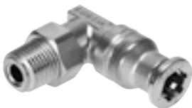
Racor rápido roscado de acero inoxidable. Máxima resistencia a la corrosión CRC 4 y a sustancias químicas; con certificación para la industria alimentaria y del envasado. Para aplicaciones neumáticas con un margen de temperatura de hasta 120 °C y un margen de presión de hasta 10 bar.
