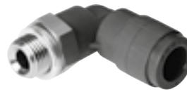
Racor rápido roscado ignífugo para la utilización en cualquier zona con peligro de incendio, por ejemplo, en equipos de soldadura en la industria automovilística o en el sector de la construcción. Para aplicaciones neumáticas con un margen de temperatura de hasta 60 °C y un margen de presión de hasta 10 bar.
