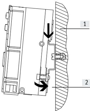
En el perfil trasero de los módulos de encadenamiento CPX se encuentra el sistema de montaje en perfil DIN. Mediante los accesorios para montaje en perfil DIN, el terminal CPX puede bloquearse sobre el perfil DIN.
