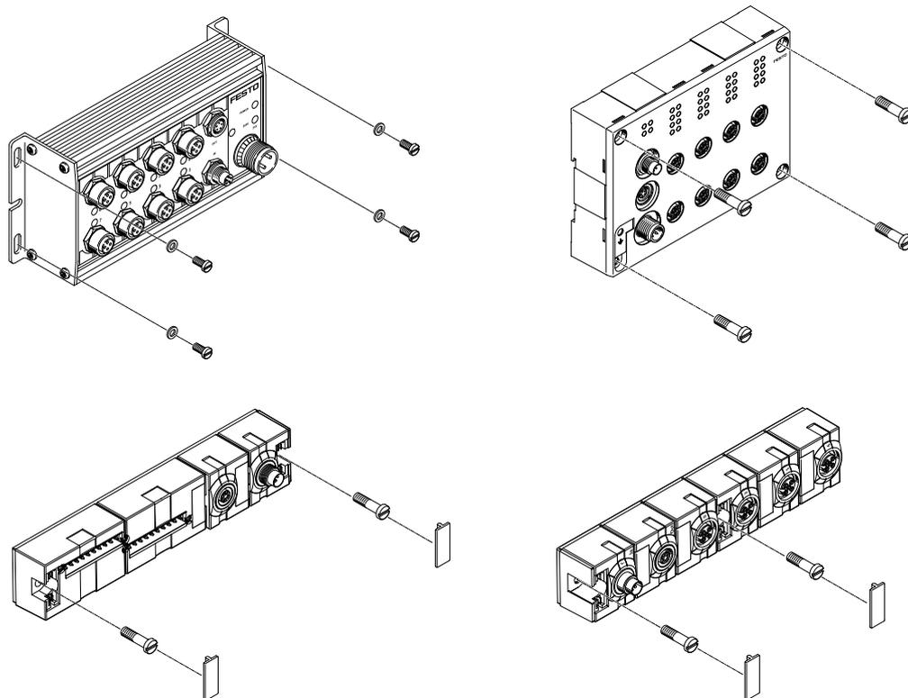
Los módulos CP pueden montarse en prácticamente cualquier superficie plana utilizando los taladros de montaje disponibles (con tornillos con diámetros de hasta 4 mm).
