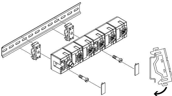
Para los módulos CP se ofrece un conjunto de fijación para el montaje en perfil DIN. En los módulos compactos, los taladros de montaje están ocultos debajo de las placas de identificación.
