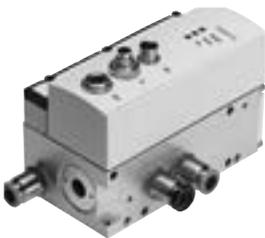
Válvula distribuidora proporcional de 5/3 vías para aplicaciones con Soft Stop y posicionamiento neumático. Plenamente digitalizada: con sensores de presión integrados y con nuevas funciones de diagnosis.
