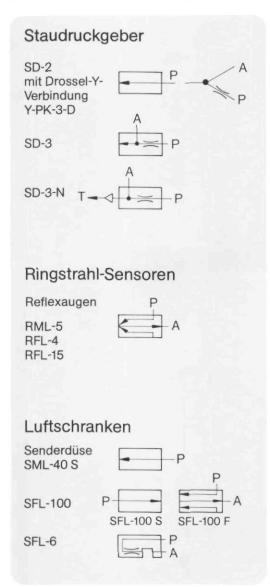
Staudruckbetätigte Ventile sind Signaleingabe-Glieder, die mittels berührungsloser Abtastung durch Luftstrahlen die Anwesenheit oder den Abstand eines Gegenstandes in Form einer Signaldruckänderung melden.
