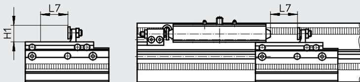
Es muss darauf geachtet werden, dass jedes Zwischenstellungsmodul während der Ein- bzw. Ausschwenkzeit im angegebenen Bereich freien Raum für die Schwenkbewegung hat. Dies entspricht dem Hub, den der Dämpferhalter aus der Zwischenposition fahren muss, damit ein sicheres Ein- bzw. Ausschwenken des Anschlags gewährleistet ist (→ Seite 21).
