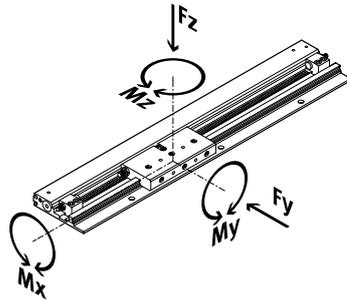
Wirken gleichzeitig mehrere der unten genannten Kräfte und Momente auf den Antrieb ein, müssen neben den aufgeführten Maximalbelastungen folgende Gleichungen erfüllt werden:
