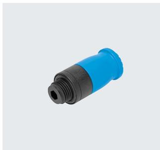
Kunststoffverschraubung für einfache Installation durch Einhandbedienung. Hydrolysebeständig, FDA konform und reinigungsfreundlich. Für Pneumatikanwendungen mit einem Temperaturbereich bis 60 °C und einem Druckbereich bis 10 bar. Schlauch-Außen- $\varnothing$  6 mm mit Anschlussgewinde G1/8.
