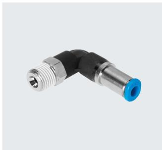
Steckverschraubung sperrt Luftstrom nach dem Lösen des Schlauchs. Für Pneumatikanwendungen mit einem Temperaturbereich bis 60 °C und einem Druckbereich bis 14 bar. Schlauch-Außen- $\varnothing$  4, 6, 8, 10 und 12 mm mit Anschlussgewinde M5, R1/8 ... R1/2 und G1/8 ... G1/2.
