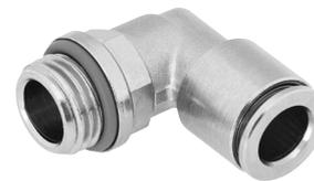
Vollmetallsteckverschraubung aus Messing, chemisch vernickelt. Hohe Korrosionsbeständigkeit KBK3 und Chemikalienresistenz. Für Pneumatikanwendungen mit einem Temperaturbereich bis 150 °C und einem Druckbereich bis 20 bar.
