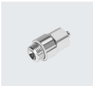
Edelstahlverschraubung für den Einsatz in reinigungsintensiven Bereichen. Höchste Korrosionsbeständigkeit KBK4. Für Pneumatikanwendungen mit einem Temperaturbereich bis 120 °C und einem Druckbereich bis 12 bar. Schlauch-Außen- $\varnothing$  6 mm mit Anschlussgewinde G1/8.
