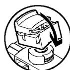
Защелкните ручной дублир на пилоте распределителя. Ручной дублир позволяет переключать распределитель без использования инструмента/принадлежностей.
