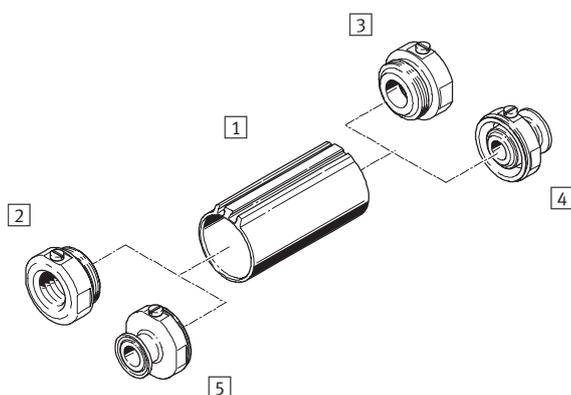
ピンチバルブVZQAは液体および気体などの制御に最適です。バルブ開時に流路に阻害要素がないため、流体の流れ抵抗が最小に抑えられ、シンプルな機構でバルブの詰まりを防止します。
