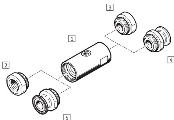
このバルブは、液体や不純物の多い流体、固体（顆粒）および混合物の遮断用に最適です。バルブ開時に流路に阻害要素がないため、流体の流れ抵抗が最小に抑えられ、シンプルな機構でバルブの詰まりを防止します。
