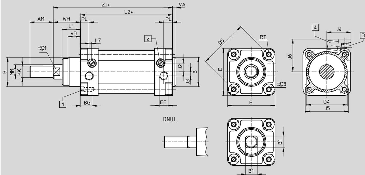
1 Vis six pans creux avec taraudage pour les éléments de fixation
