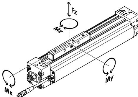
Si plusieurs des forces et couples mentionnés ci-dessous agissent simultanément sur l'actionneur, respectez les charges maximales indiquées et appliquez l'équation suivante :
