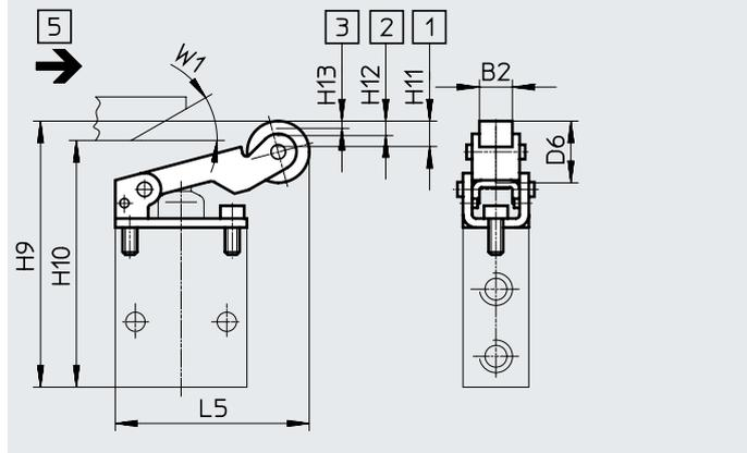
Dispositivo de accionamiento de palanca con rodillo abatible AL-01 para válvula accionada por leva V/O-3-1/8
