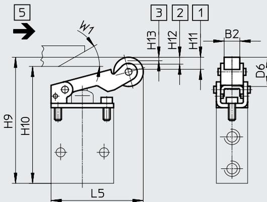
Dispositivo de accionamiento de palanca con rodillo abatible AL-01 para válvula accionada por leva V/O-3-1/8
