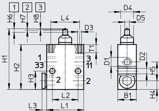
Dispositivo de accionamiento de palanca de rodillo AR-01 para válvula accionada por leva V/O-3-1/8
