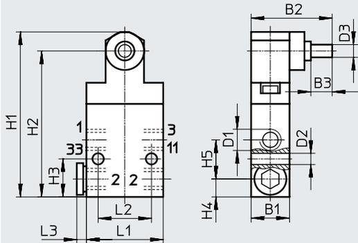
Válvula de palanca basculante RW-3-M5
