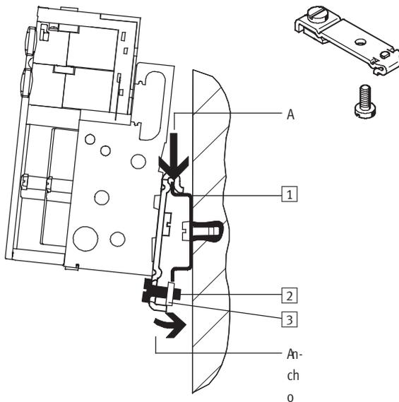
El terminal de válvulas se cuelga en el perfil DIN (ver flecha A). A continuación se presiona el terminal de válvulas y se fija mediante la pieza de bloqueo (ver flecha B).
