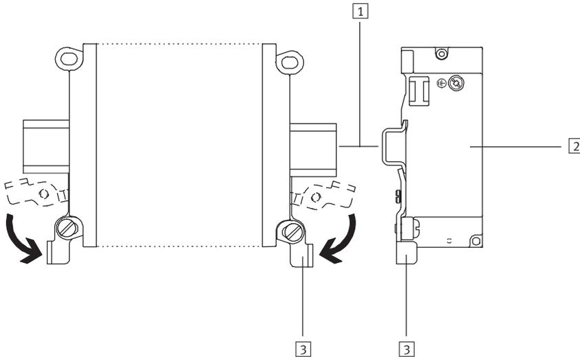
El terminal de válvulas se monta en un perfil DIN y se fija mediante la palanca.
