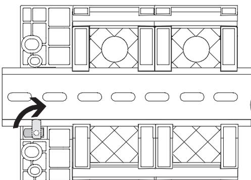
Perfil DIN en la parte posterior de los módulos CPX. Los módulos pueden fijarse en el perfil DIN.
