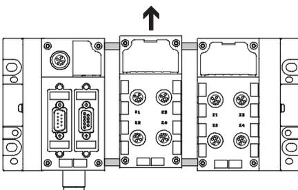
La construcción abierta permite el intercambio de los bloques de distribución estando montada la unidad. El kit de tirantes adicionales permite agregar un módulo al terminal CPX.
