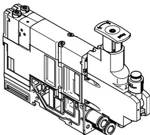
En cada posición de válvula pueden intercarse otras unidades funcionales entre la placa básica y la válvula.
