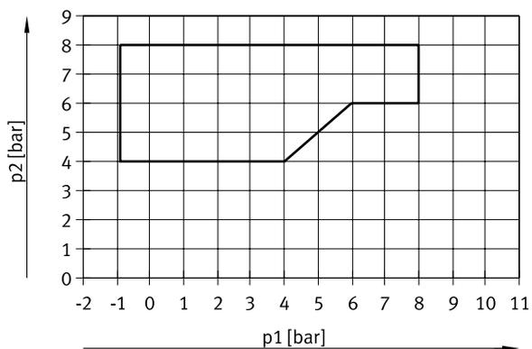
Para válvulas de ancho de 20 mm con código de función de posición 1-32: MS, NS, KS, HS, DS
