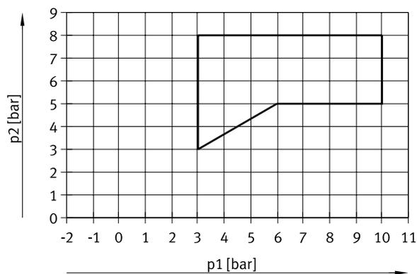
**Presión de mando p2 en función de la presión de trabajo p1 para válvulas con reposición por muelle mecánico**
