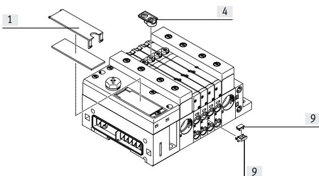
Para identificar las válvulas puede montarse en cada placa base un soporte para placas identificadoras VMPAL-ST-AP-10 (n.º art. 561109) para placas de identificación (n.º art. 18576, IBS-6x10).
