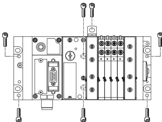
El terminal de válvulas MPA-L se atornilla a la superficie de fijación mediante cuatro tornillos M4 y dos tornillos M6 o con seis tornillos M6. Los taladros de fijación se encuentran en la placa final izquierda y derecha y en la interfaz neumática.
