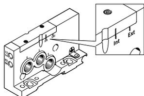
Si la presión de alimentación del terminal es de entre 0,3 y 0,8 MPa, puede optarse por una alimentación interna del aire de pilotaje. En ese caso, el aire de pilotaje se deriva del canal 1 mediante una conexión
