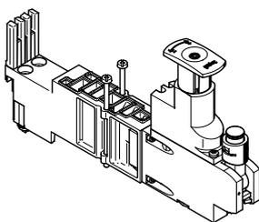
Para controlar la fuerza de los actuadores accionados, se puede montar un regulador de presión ajustable entre la placa básica y la válvula correspondiente.
