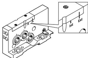
Si la presión de alimentación (en la placa final derecha) es inferior a 0,3 MPa o superior a 0,8 MPa, deberá optarse por una alimentación externa del aire de pilotaje para el terminal de válvulas MPA-L. Para ello, el aire de pilotaje se alimenta a través de la cone-
