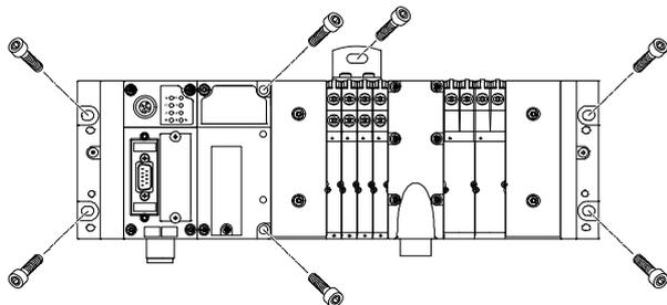
El terminal de válvulas MPA-F se fija a la superficie mediante seis tornillos M6. Los taladros de montaje se encuentran en la placa final del lado izquierdo (CPX) y en la placa final del lado derecho (MPA-F).
