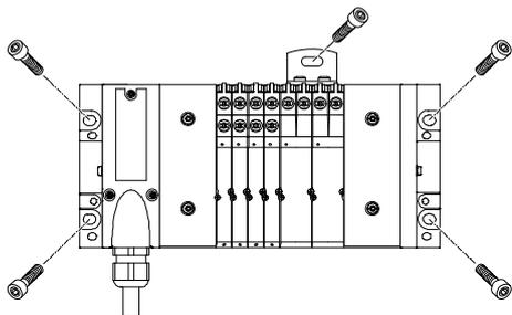
El terminal de válvulas MPA-F se fija a la superficie mediante cuatro tornillos M6. Los taladros de fijación se encuentran en la interface neumática
