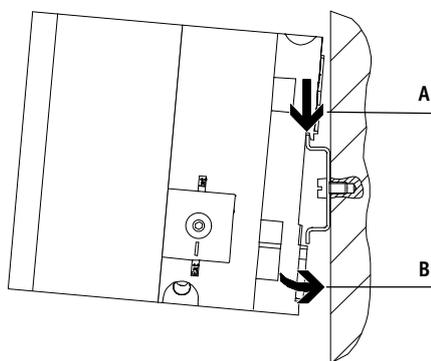
El terminal de válvulas MPA-F se cuelga en el perfil DIN (ver flecha A). A continuación se gira el terminal MPA-F y se fija con las piezas de bloqueo (ver flecha B).
