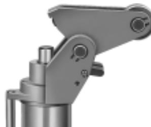
**Mecanismo de bloqueo para desconexión de la función de parada:** para que el portaobjetos pueda pasar por encima del balancín sin que para ello tenga que activarse el cilindro.
