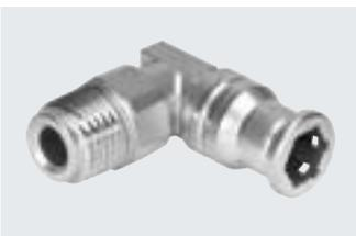
Racor rápido roscado de acero inoxidable. Máxima clase de resistencia a la corrosión CRC 4 y a sustancias químicas; con certificación para la industria alimentaria y del envasado. Para aplicaciones neumáticas con un margen de temperatura de hasta 120 °C y un margen de presión de hasta 10 bar.
