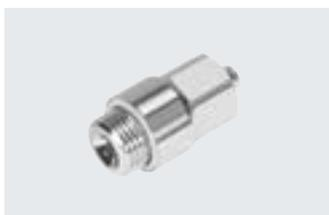
Racor de acero inoxidable para el uso en áreas expuestas a limpieza intensiva. Máxima clase de resistencia a la corrosión CRC 4. Para aplicaciones neumáticas con un margen de temperatura de hasta 120 °C y un margen de presión de hasta 12 bar.
