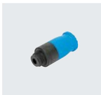
Racor de plástico para una instalación sencilla gracias al manejo con una sola mano. Resistente a la hidrólisis, conforme con las especificaciones de la FDA y de fácil limpieza. Para aplicaciones neumáticas con un margen de temperatura de hasta 60 °C y un margen de presión de hasta 10 bar.
