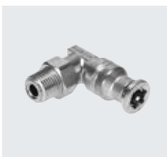
Racor rápido roscado de acero inoxidable. Máxima resistencia a la corrosión CRC 4 y a sustancias químicas; con certificación para la industria alimentaria y del envasado. Para aplicaciones neumáticas con un margen de temperatura de hasta 120 °C y un margen de presión de hasta 10 bar.
