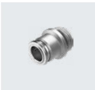
Racor rápido roscado de acero inoxidable. Máxima resistencia a la corrosión CRC 4 y a sustancias químicas. Para aplicaciones neumáticas con un margen de temperatura de hasta 150 °C y un margen de presión de hasta 16 bar. Diámetro ext. tubo flexible 4, 6, 8, 10 y 12 mm con rosca de conexión M5, M7 y G1/8 ... G1/2.
