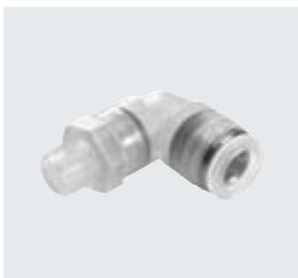
Racor de polipropileno, ideal para aplicaciones bajo condiciones de fluidos extremas. Para aplicaciones neumáticas con un margen de temperatura de hasta 60 °C y un margen de presión de hasta 10 bar.
