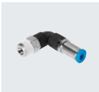
El racor rápido roscado bloquea el flujo de aire después de soltarse el tubo flexible. Para aplicaciones neumáticas con un margen de temperatura de hasta 60 °C y un margen de presión de hasta 14 bar.
