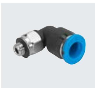
Racor rápido roscado de pequeñas dimensiones para lograr la máxima densidad de montaje en espacios reducidos. Para aplicaciones neumáticas con un margen de temperatura de hasta 80 °C y un margen de presión de hasta 14 bar.
