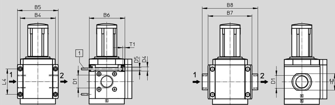
[1] Tornillo M6xmin.90 según DIN 912 (no incluido en el suministro) para montaje en la pared sin escuadra de fijación
