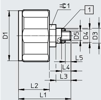
[1] Con anillo de junta de poliamida premontado en fábrica
