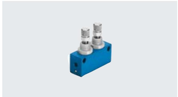
Se trata de dos válvulas de estrangulación y antirretorno montadas en un solo cuerpo y unidas entre sí. De esta manera es posible, p. ej., ajustar por separado la velocidad de avance y la de retroceso con cilindros en miniatura de doble o simple efecto.
