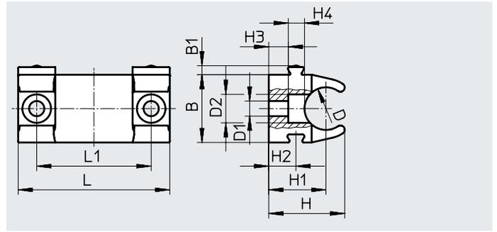
Encadenamiento de varios soportes mediante ranura de cola de milano
