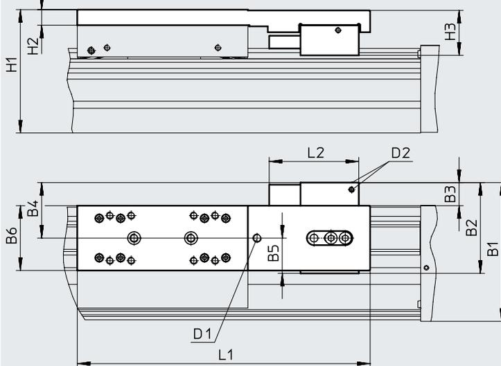
D2 Conexión de aire comprimido
