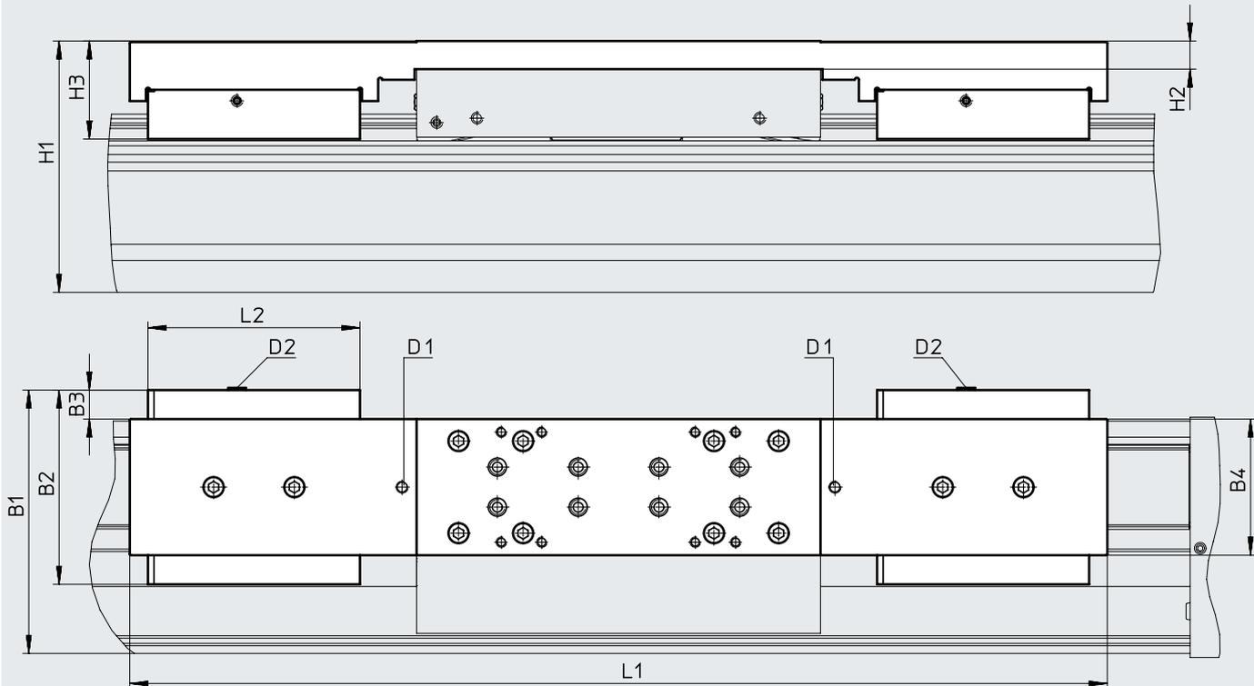
D2 Conexión de aire comprimido
