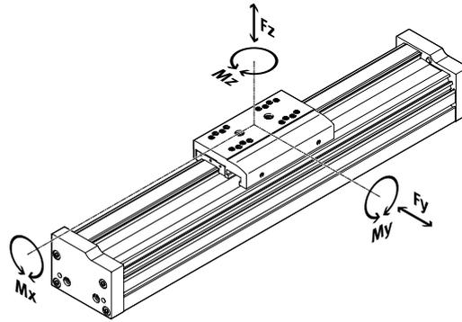
Si el eje está expuesto simultáneamente a varios de los momentos y fuerzas indicados más abajo, además de las cargas máximas indicadas deberá cumplirse la siguiente ecuación:
