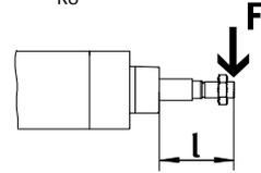
Fuerzas transversales máximas admisibles  $F_{y_{m\acute{a}x}}$  y  $F_{z_{m\acute{a}x}}$  sobre el vástago en función de la longitud l de la carrera
