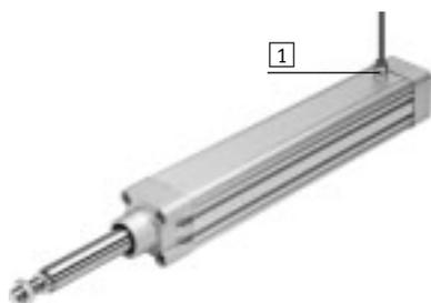
El cilindro eléctrico con IP65 cumple los criterios de la norma IEC 60 529. La presión se compensa a través de un taladro [1] que se encuentra en la camisa del cilindro. De esta manera se evita que se produzca vacío o presión dentro del cilindro.
