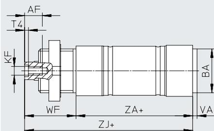
MG-K3 – Culata delantera sin rosca de fijación, con rosca interior en el vástago
