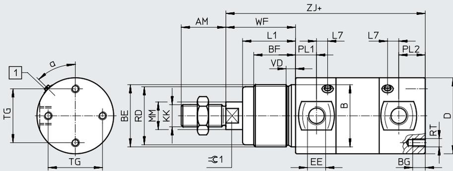
[1] Tornillo de regulación para amortiguación de fin de recorrido
