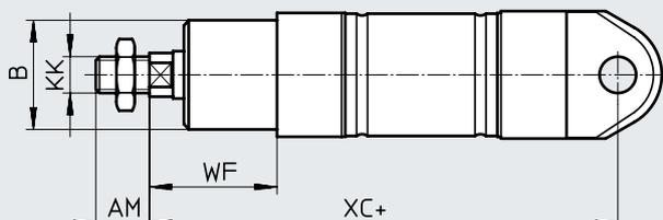
MQ-K3 – Culata posterior corta sin fijación basculante, con rosca interior en el vástago
