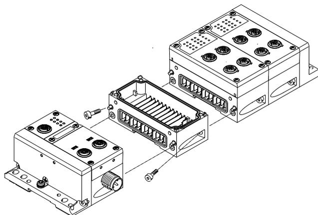
Los módulos CPX-P se unen entre sí mecánicamente mediante tornillos inclinados. De esta manera, el terminal CPX-P puede ampliarse en cualquier momento de forma flexible.
