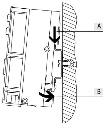
En el perfil trasero de los módulos de encadenamiento CPX-P se encuentra el sistema de montaje en perfil DIN. El terminal CPX-P puede bloquearse en el perfil DIN mediante las fijaciones para perfil DIN. Para ello, el terminal CPX-P se engancha en el perfil DIN (véase la flecha A).
