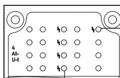
[1] Diodo emisor de luz de error (rojo; error de módulo)
