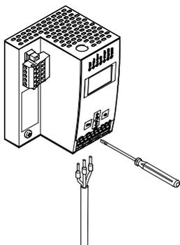
Las conexiones de la red AS-Interface y de la alimentación de tensión para el gateway y el AS-Interface se realizan mediante una regleta de bornes.
