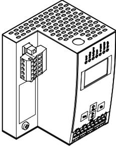
Los gateways de AS-Interface sirven para conectar la red AS-Interface a un bus de campo superior. Se comportan como master en la red AS-Interface y como slave en la red de bus de campo.
