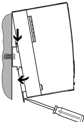
El gateway se monta en un perfil DIN. En el dorso de la unidad se encuentran los correspondientes elementos de fijación.
