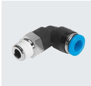
Breite Auswahl an Steckverschraubungen für Pneumatikanwendungen mit einem Temperaturbereich bis 80 °C und einem Druckbereich bis 14 bar. Schlauch-Außen- $\varnothing$  4, 6, 8, 10, 12, 16 und 22 mm mit Anschlussgewinde von R1/8 ... R1/2 und G1/8 ... G3/4.
