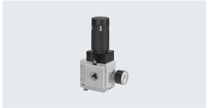
Der Ausgangsdruck p2 ist innerhalb des Druckregelbereichs entweder manuell mit dem Drehknopf oder pneumatisch über einen Steuerdruck p12 von einem externen Pilotregler (möglichst mit einem Präzisions-Druckregelventil) einstellbar. Beim Abschalten des Eingangsdrucks p1 wird der Ausgangsdruck p2 über den Anschluss 3 (Sekundärentlüftung) entlüftet.
