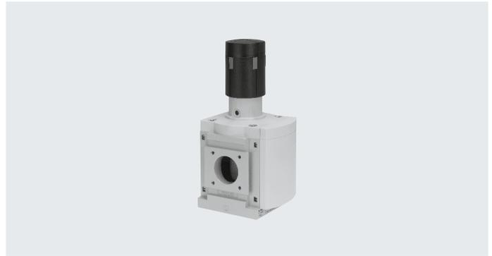
Das Druckregelventil hält den Ausgangsdruck p<sub>2</sub>, unabhängig von Druckschwankungen im Netz und vom Luftverbrauch, weitgehend konstant. Der Ausgangsdruck p<sub>2</sub> ist innerhalb des Druckregelbereichs entweder manuell mit dem Drehknopf oder pneumatisch über einen Steuerdruck p<sub>12</sub> von einem externen Pilotregler einstellbar. Beim Abschalten des Betriebsdrucks wird der Ausgangsdruck p<sub>2</sub> über den Anschluss 3 (Sekundärentlüftung) entlüftet.
