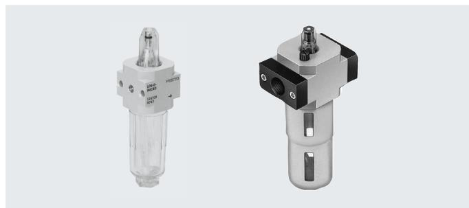
Der Proportional-Öler führt der Druckluft eine fein dosierbare Ölmenge zu. Das Druckgefälle, das beim Durchströmen einer Venturidüse entsteht, wird benützt, um aus einem Behälter Öl bis zur Abtropfkappe zu fördern.
