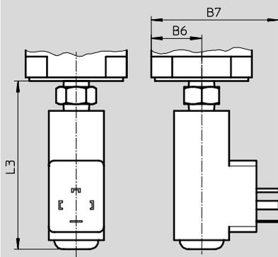
Druckschalter PEV-1/4-B-0D mit einstellbarem Druckschaltpunkt, Stecker, viereckige Bauform nach EN 175 301, Form A
