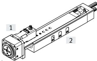
Bei der Kombination ERMO-12 mit DGSL-12 kann beim ERMO der Näherungsschalter SIEN als Referenzschalter nicht genutzt werden.
