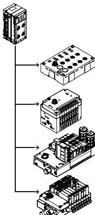
Elektrické pripojení CPX CTEL master zajišťuje propojení k modulům s rozhraním I-Port (zařízení) z řady CTEL/CTEU. Vstupní/výstupní data připojených zařízení se přenášejí na připojený síťový uzel CPX a pak po síti do nadřízeného automatu. Prostřednictvím odpovídajících rozhraní M12 lze k zařízení CPX CTEL master připojit maximálně 4 zařízení.
