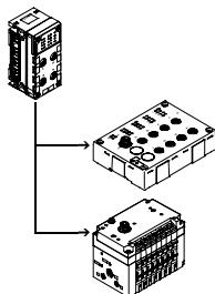
Elektrické připojení CPX CTEL master zajišťuje propojení k modulům s rozhraním I-Port (zařízení) z řady CTEL/CTEU. Vstupní/výstupní data připojených zařízení se přenášejí na připojený síťový uzel CPX a pak po sítí do nadřízeného automatu. Odpovídajícími rozhraními M12 lze připojit maximálně dvě zařízení IO-Link k jednomu elektrickému připojení CPX-CTEL-2-....
