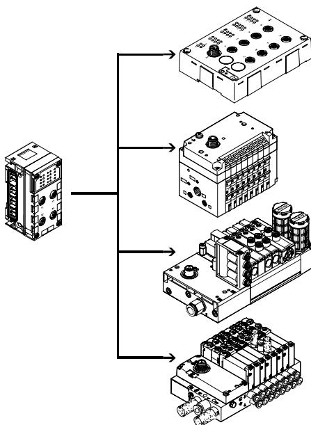
Zařízení CPX CTEL master poskytuje 4 rozhraní I-Port, přičemž ke každému z nich lze připojit jedno zařízení. I-Port je rozhraní pro sériový přenos dat k decentralním modulům nebo ventilovým terminálům Festo. Rozhraní I-Port vychází z technologie IO-Link, takže v určitých oblastech je s ní kompatibilní. Topologie systému je hvězdicová. To znamená, že na každý I-Port lze připojit pouze jeden modul nebo jeden ventilový terminál.
