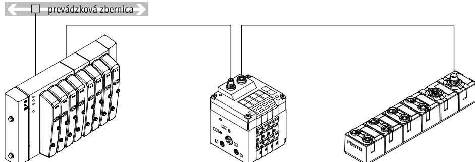
Ventilové terminály CDVI-DN s pripojením prevádzkovej zbernice môžu byť osadené 4, 6, 8 alebo 12 ventilovými pozíciami a 4 až 24 ventilovými cievkami.
