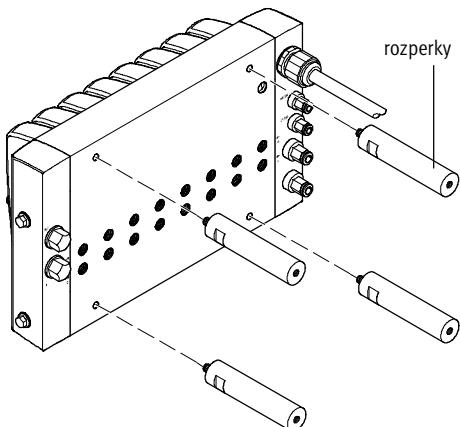
Pomocou štyroch závitových otvorov v základnom bloku a rozperkami uvedenými v objednávacom kóde (príslušenstvo s objednávacím kódom Y) je možné terminál CDVI upevniť priamo na uzemnené upevňovacie plochy.
