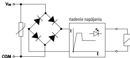
Každá elektromagnetická cievka ventilu je zabezpečená chráneným obvodom pre zhášanie iskier a proti prepôlovaniu.
