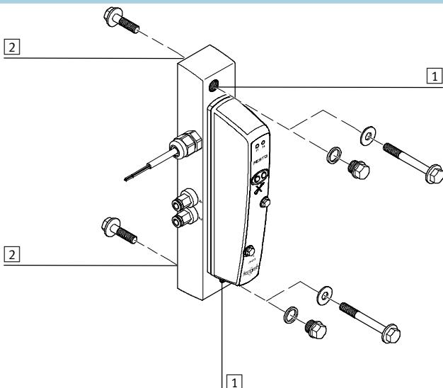
[1] otvor pre čelné upevnenie (CDSV)
