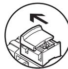
キャップを反対方向にスライドさせて手動操作を解放します。
