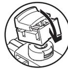
手動操作ボタン上にキャップを押し込み固定させます。
