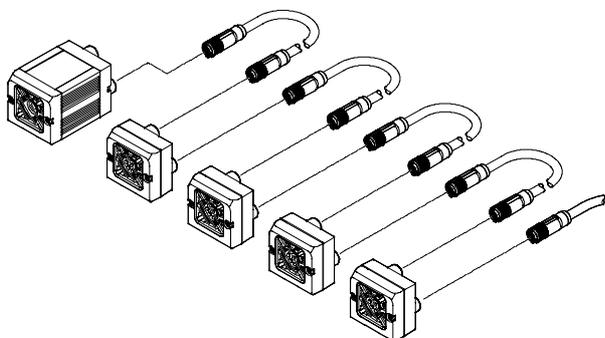
Connexion d'anneaux externes SBAL-C6-R sur le capteur de vision SBS. Possibilité de connecter jusqu'à 2 anneaux directement au SBS.
