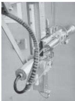
Environnement « rayonnant » de près de 4 Sievert/h et mise en œuvre dans de l'eau entièrement déminéralisée dans un manipulateur assurant le démontage de cuves sous pression et d'écrans thermiques.
