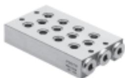
Las válvulas Tiger Classic pueden montarse en perfiles distribuidores con toma de aire comprimido común o en bloques distribuidores con toma de aire comprimido común y descarga común también. Las válvulas se montan en perfiles o bloques distribuidores mediante tornillos huecos. El listón distribuidor y el bloque distribuidor tienen desde 2 hasta 6 posiciones de válvulas.
